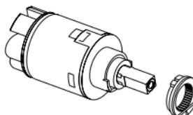
**La cartuccia viene fornita con la ghiera in posizione centrale in modo da consentire il pieno utilizzo di acqua calda e di acqua fredda.**
