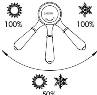
Orientando la ghiera verso destra o verso sinistra tramite una regolazione millimetrica, si può diminuire od aumentare la portata di acqua calda o di acqua fredda.
